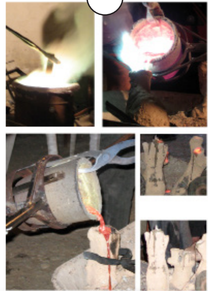
Coulage : remplissage du moule par du bronze liquide très chaud.
