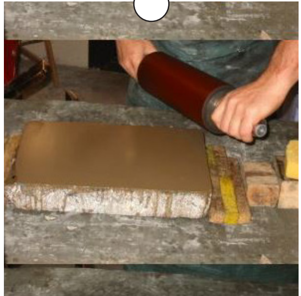
Encrage au rouleau du dessin sur la pierre
