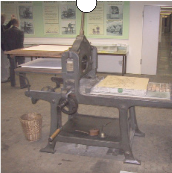
Impression du dessin couvert d'encre sur le papier
